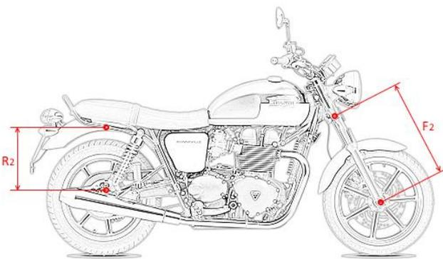
4) Appoggiare la moto a terra con entrambe le ruote, comprimere lentamente la sospensione un paio di volte e lasciandola poi estendere liberamente.
