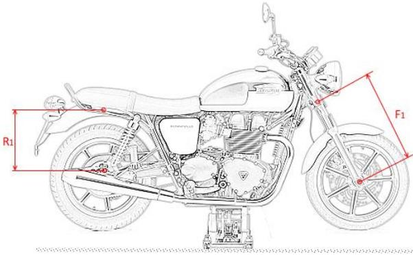
1) Sollevare la moto (forcellone libero dal carico, e ruota sollevata dal terreno) e comprimere la contromolla, forzando la completa estensione del cinematismo della sospensione posteriore. Effettuare la stessa operazione per l'avantreno.
