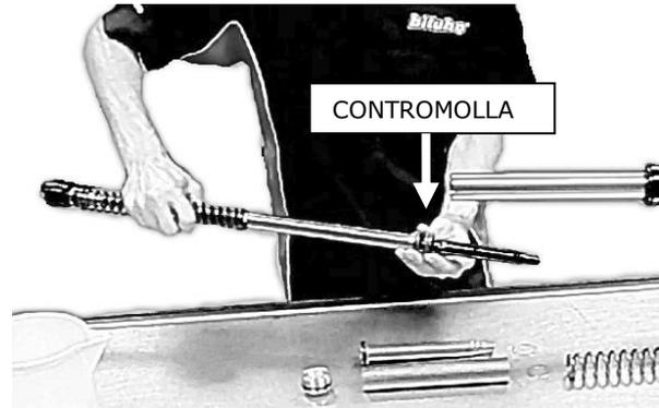
13. Mantenendo lo stelo sul fondo del fodero inserire la cartuccia BITUBO dentro alla forcella e fissarla con la vite a brugola e rondella originali, serrando adeguatamente con la coppia di serraggio indicata dalla casa madre.
