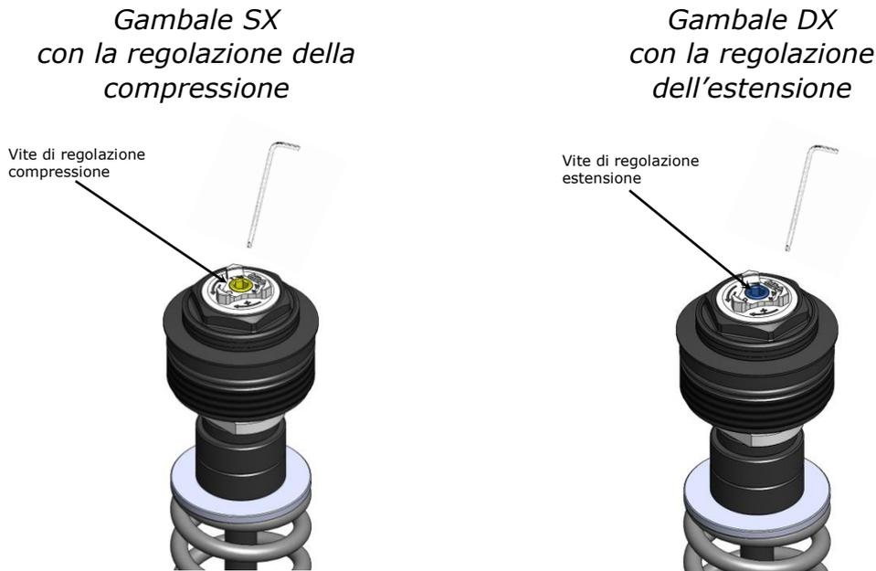
Entrambe le regolazioni della forza di smorzamento possono essere eseguite mediante una comune chiave a brugola con testa sferica di 4mm.
