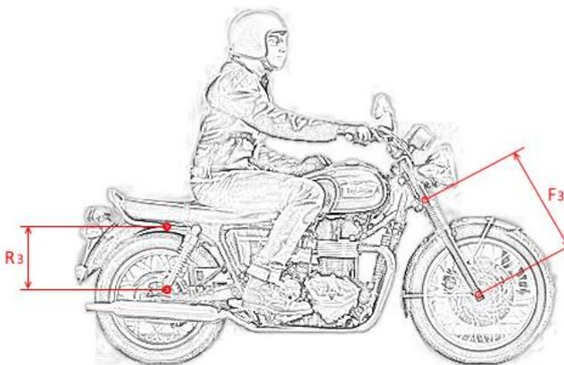
7) Ripetere l'operazione di misurazione con il guidatore sopra la moto in posizione di guida (*SAG PILOTA*).
