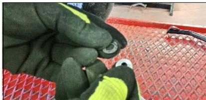
**ITA** Imboccare le due rondelle aramidiche (9) nei due distanziali(8), per poi posizionarle nella parte posteriore del paracalore in corrispondenza dei fori
