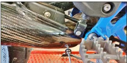
**ITA** Inserire la vite a testa bombata M5x20 (6) con due rondelle aramidiche (9) nella parte frontale del paracalore in corrispondenza del foro singolo
