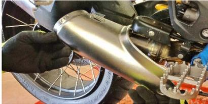
**ITA** Iniziare rimuovendo il piccolo paracalore svitando le viti di sostegno
