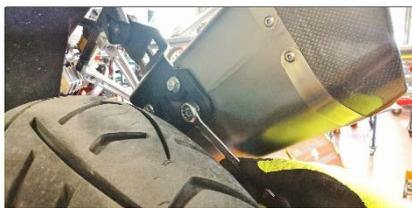
**ITA** Serrare tutte viti partendo da quelle della staffa di fissaggio silenziatore, poi la vite di fissaggio staffa al telaio e infine la fascetta innesto posizionandola come in foto.
