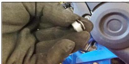
**ITA** Imboccare la rondella 5x15 (10) nel distanziale (11), per poi posizionarli nella parte posteriore del paracalore in corrispondenza del foro singolo
