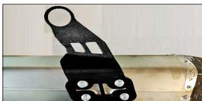
**ITA** Fissare la staffa di supporto (2) al silenziatore (1) usando le quattro viti (4) in dotazione senza serrare
