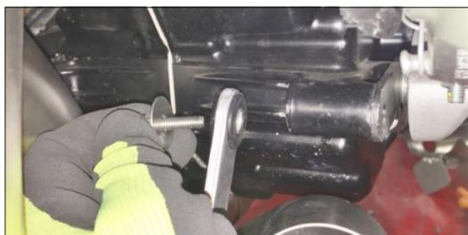
**ITA** Avvitare, dove prima era avvitata la bielletta di serie, la bielletta in dotazione al carter motore senza serrare usando la vite (4) e la rondella (7) in dotazione
