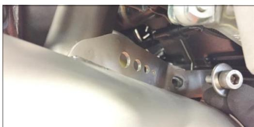
**ITA** Avvitare la staffa supporto silenziatore alla bielletta usando la rondella (6) e la vite (5) posizionandole davanti alla staffa e usando la rondella (6) e il dado (8) posizionandoli dietro la staffa
