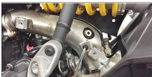
**ITA** Rimuovere la vite destra di supporto paracalore grigio dell'attacco testa verticale
