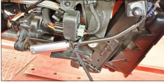
**ITA** Fissare il cavo con una fascetta in plastica al connettore motorino valvola come in foto
