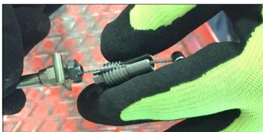
**ITA** Inserire il cavo nella sede e avvitare il corpo regolatore fino a battuta, serrare con chiave da 8 per il corpo regolatore cavo valvola e chiave da 10 per il dado presente sul cavo.
