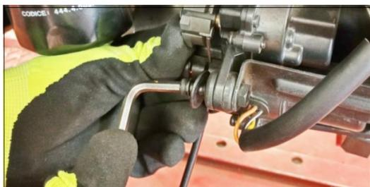
**ITA** Svitare il motorino valvola e riavvitarlo ruotato di 180 gradi
