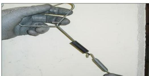
**ITA** Inserire le gomma alle molle lunghe (10) e corte (9) usando il tiramolle (13) in dotazione
