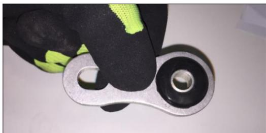
**ITA** Posizionare il distanziale di gomma (12) e di alluminio (11) in corrispondenza del foro della bielletta (3) in dotazione, come mostrato in foto
