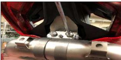
Fissare la fascetta (37) del corpo finale alla staffa (36) con le viti (29) e avvitarle ma senza serrare completamente per mantenere un minimo movimento del tubo finale.
