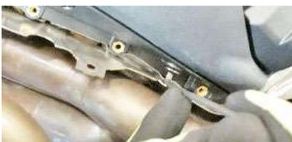
Svitare la vite del coperchietto copricavi (sopra al serbatoio
