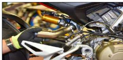
Inserire l'attacco testa posteriore sinistro (4) e fissarlo con i dadi originali partendo da quello in basso a destra
