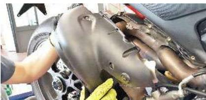
Svitare completamente la vite del paracalore
