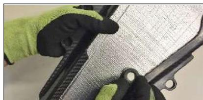
Inserire il gommino passacavo (50) nel foro centrale del paracalore serbatoio in carbonio
