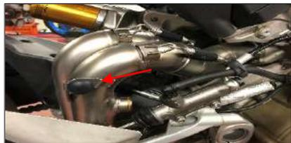
Inserire il collettore verticale (6) e fissarlo mediante 4 molle (15) usando il tiramolle (42)
