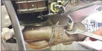
Svitare sonda lambda collettore inferiore
