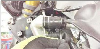
Inserire il collettore orizzontale (5) e mettere le 4 molle (15). Inserire i tappi (45) con le rosette (40). In alternativa è possibile montare il sensore di serie utilizzando i tappi (46) e le rosette (40) e (44)
