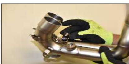
Mettere i 2 tappi (45) con rosette (40) sui collettori verticali. In alternativa è possibile la sonda originale con i tappi (46) e le rosette (40) e (44)
