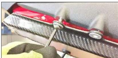
Fissare il particolare ai 4 fori degli attacchi pedane passeggero usando le quattro viti (32), appoggiandole senza serrare
