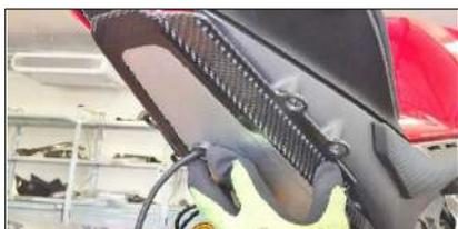
Posizionare il paracalore serbatoio in carbonio (27)
