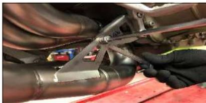
Fissare il collettore alla staffa (11) con la vite (25), il dado (24) e la rosetta (23) utilizzando la coppia di serraggio riportata a pagina 29
