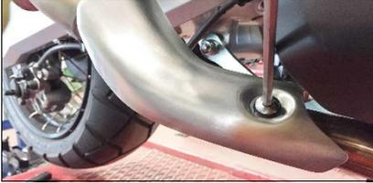
**ITA** Rimuovere il paracalore originale svitando la vite di sostegno
