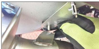
**ITA** Posizionare la staffa (1) in corrispondenza dell'asola della staffa del silenziatore e fissare le staffe con la rondella (6) e dado (4) in dotazione
