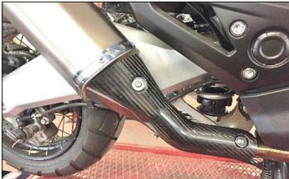
**ITA** Posizionare la vite (9) con la rondella (6), nella parte larga del paracalore, all'esterno in corrispondenza del foro. All'interno invece posizionare la rondella aramidica (5) e il distanziale (3) e avvitare il paracalore alla staffa (1).
