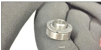
**ITA** Posizionare il distanziale (8) con la rondella aramidica (5), nella parte stretta del paracalore, all'interno in corrispondenza del foro. All'esterno invece posizionare rondella (6) e vite (9) e fissare il paracalore alla staffa del collettore originale
