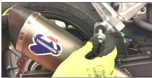
**ITA** Fissare la staffa di supporto al silenziatore usando la vite, rondella e dado originale senza serrare
