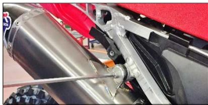
**ITA** Fissare i silenziatori al telaio con le viti M8x35 e le rondelle 8x24, in dotazione, partendo dal silenziatore sinistro
