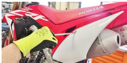
**ITA** Svitare le viti di fissaggio delle fiancatine lato destro e lato sinistro
