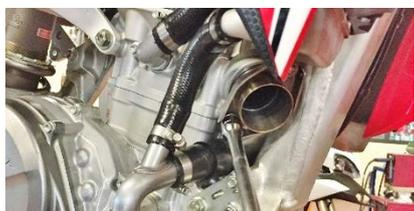
**ITA** Montare la ghiera sulla boccola e alloggiarle nell'attacco testa, fissandole con i dadi originali senza serrare
