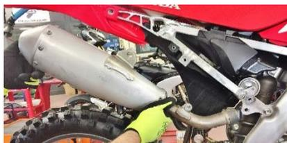
**ITA** Rimuovere i silenziatori svitando le viti di fissaggio al telaio
