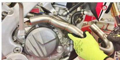
**ITA** Inserire il collettore nella boccola e fissarlo con la molla corta con gommino, utilizzando il tira-molla in dotazione
