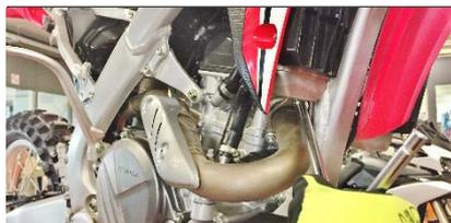
**ITA** Svitare i dadi della ghiera sul collettore, conservandoli per il montaggio del Kit Termignoni
