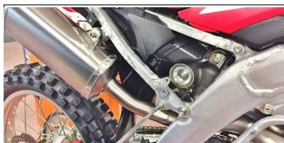
**ITA** Fissare curva silenziatori al telaio con le viti M8x20 e le rondelle 8x16, in dotazione, partendo dal silenziatore sinistro
