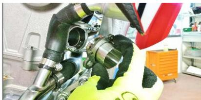
**ITA** Montare la ghiera sulla boccola e alloggiarle nell'attacco testa, fissandole con i dadi originali senza serrare
