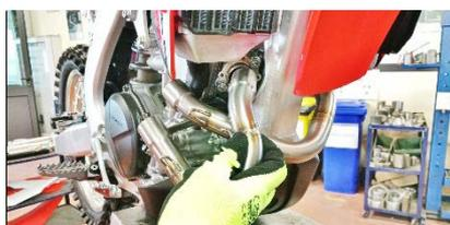
**ITA** Ora inserire il collettore destro nella boccola e fissarlo con la molla corta con gommino, utilizzando il tira-molla in dotazione
