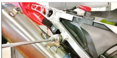
**ITA** Fissare i silenziatori al telaio con le viti M8x35 e le rondelle 8x24, in dotazione
