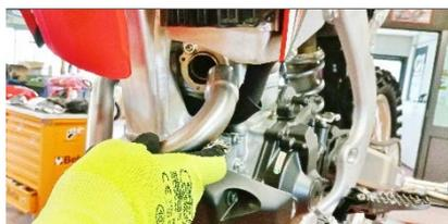
**ITA** Inserire prima il collettore sinistro nella boccola e fissarlo con la molla corta con gommino, utilizzando il tira-molla in dotazione
