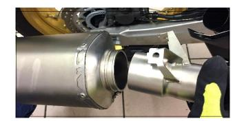
**ITA** Innestare il tronchetto nel silenziatore **ENG** Insert the socket in the silencer
