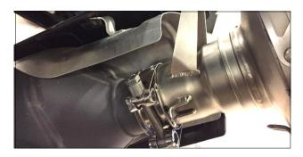
**ITA** Inserire la molla sugli appositi ganci **ENG** Insert the spring on the appropriate hooks
