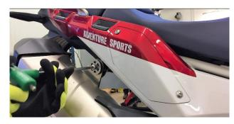
ITA Svitare la vite della staffa supporto silenziatore **ENG** Unscrew the screw of the silencer support bracket
