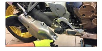
ITA Rimuovere il paracalore grigio svitando le viti di sostegno **ENG** Remove the grey heat shield unscrewing the support screws
