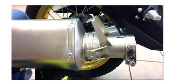
**ITA** Inserire la fascetta innesto, in dotazione, sul tronchetto **ENG** Insert the supplied strap clamp on the socket
