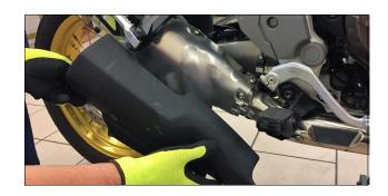
ITA Rimuovere il paracalore nero svitando le viti di sostegno **ENG** Remove the black heat shield unscrewing the support screws
