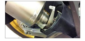
**ITA** Posizionare le mollette sulle staffe del collettore **ENG** Put the clips on the collector brackets
