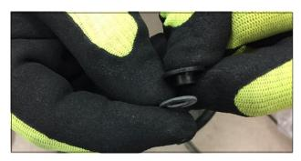
ITA Posizionare la rondella aramidica e il distanziale nella parte posteriore del paracalore in corrispondenza dei fori ENG Place the washers and spacers in the rear part of the heat shield at the holes
