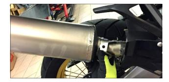
ITA Imboccare il silenziatore assemblato al collettore di serie, mandandolo in battuta come in foto, per poi fissarla con la vite testa cilindrica M8x30 e la rondella 8x16 in dotazione
