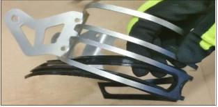
ITA Alloggiare la fascetta supporto sul silenziatore e fissarla al telaio della moto, usando il distanziale in alluminio in dotazione, la vite a testa bombata M8x55 in dotazione e la rondella originale, senza serrare ENG Enter the ring holder onto the silencer and fix them to the frame, using the aluminum spacer, the screw M8x60, in the pack, and the original washer, without tightening
