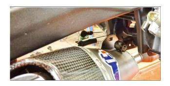
**ITA** Posizionare la staffa dietro il supporto del telaio, come in foto. **ENG** Position the bracket behind the frame support, as shown in the picture.
