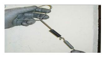
NOTA: Inserire la gomma alla molla come mostrato nella foto. : Insert the rubber to the spring as shown in the picture.
