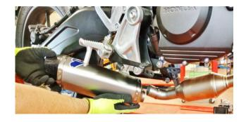
**ITA** Inserire il silenziatore Termignoni al collettore catalizzato. **ENG** Insert the Termignoni silencer to the catalyzed collector.
