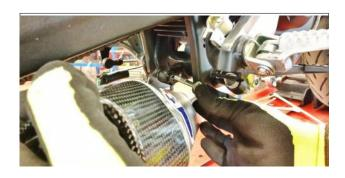
**ITA** Fissare il silenziatore al telaio usando la vite di serie precedentemente smontate e il dado in dotazione, senza serrandole
