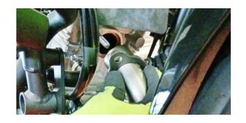
**ITA** Montare il collettore Termignoni inserendo boccola e ghiera nell'apposita sede, fissandola con i dadi originali senza serrare.
