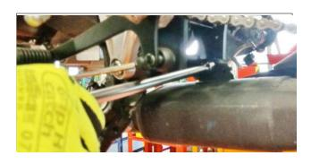
**ITA** Svitare la vite della staffa supporto silenziatore tenendoli per il montaggio del kit Termignoni e rimuovere lo scarico originale.
