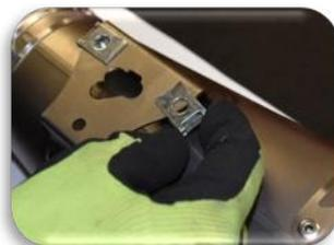
• Inserir il silenziatore sul corpo centrale e fissarlo alla staffa con la vite e rondella in dotazione ( Fig.23)
