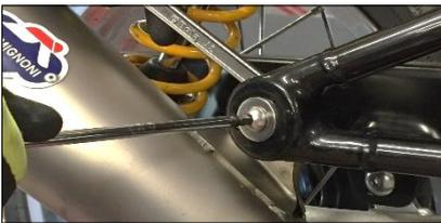
**ITA** Serrare tutte viti partendo da quella di fissaggio staffa al telaio e infine la fascetta innesto.
