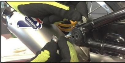
**ITA** Fissare la staffa al telaio della moto usando la vite a testa bombata M8x35, la rondella M8x24 e distanziale in dotazione, posizionandoli come in foto, senza serrare
